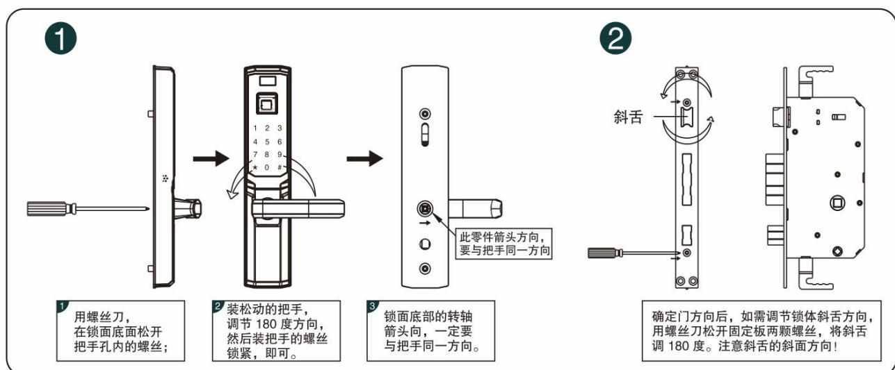
2、锁体方向调节好后，安装锁体，上紧锁住固定板上的四颗螺丝。然后安装前后面板锁螺丝。
